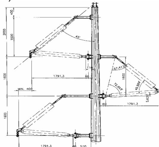
Figura G-4: Esempio di palo monostelo in acciaio a tronchi innestabili
