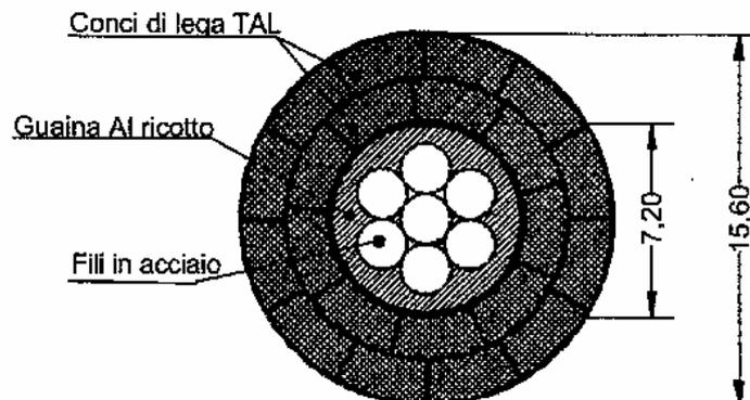
Figura G-2: Composizione del conduttore unificato AT Enel ad alto limite termico di diametro 15,6 mm
