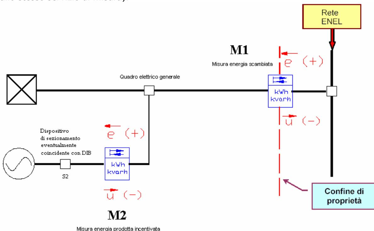
*Figura H-1 Schema di collegamento dei sistemi di misura Enel presso un Cliente produttore con servizio di scambio sul posto o che effettua la cessione "parziale" in rete dell'energia prodotta.*
