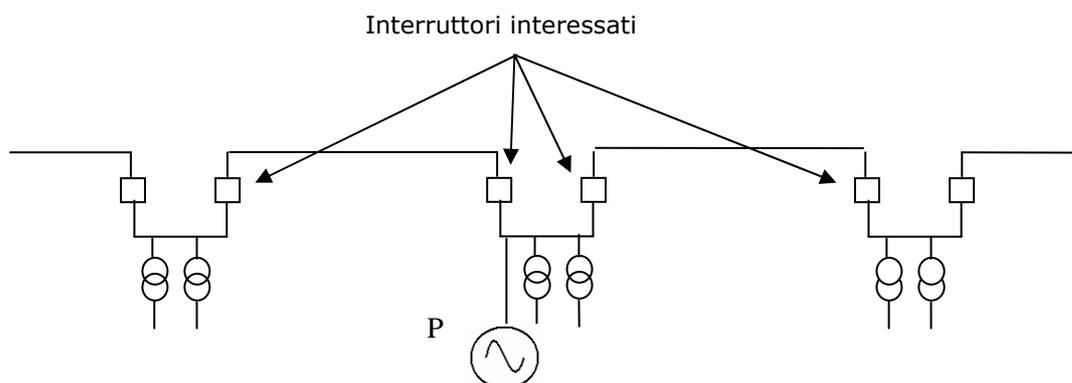
**Figura E-7- Produttore connesso in antenna**
