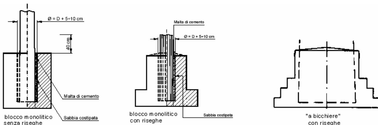
Figura G-13: Tipologie di fondazioni unificate Enel
